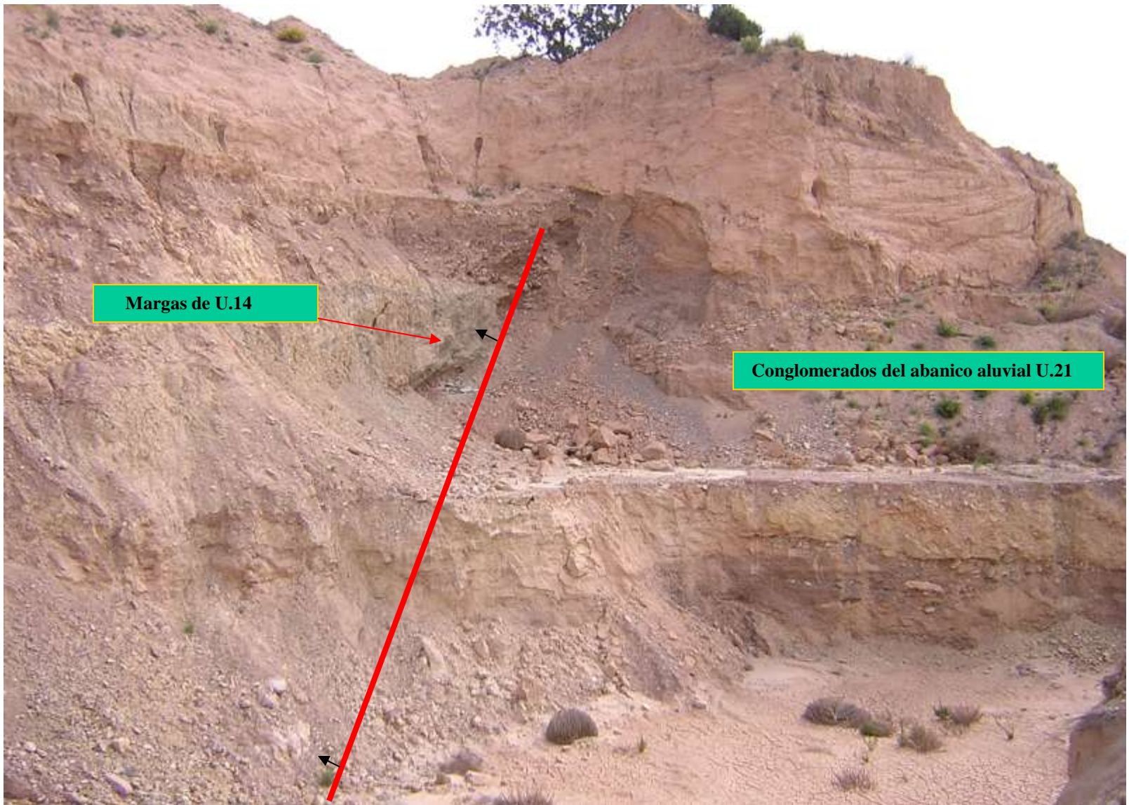
26-38-IN-FL-F 12.- La Falla de la Murta en la cantera de áridos situada el la margen izquierda de la rambla de este nombre, en el paso de la E-5 sobre el cauce.
